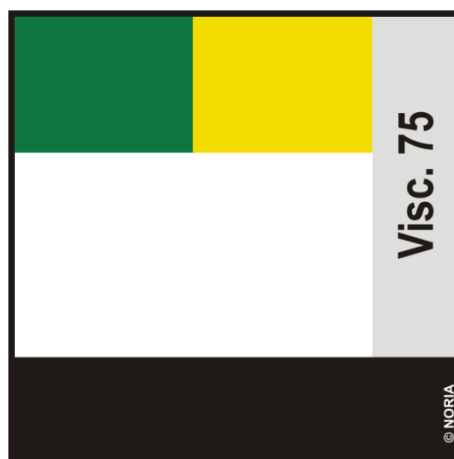
Figura 9 - Exemplo de etiqueta com viscosidade que não se enquadra em qualquer categoria ISO para lubrificante líquido (óleo)
